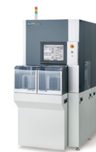
DFP8141 サファイアやSiCなど 硬脆材料の加工に特化した CMPポリッシャ
