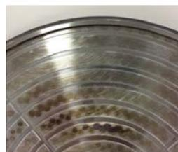
ポーラス貼り付け面に傷がある場合、そこで凸凹が発生し、バキュームを繰り返すことにより精度が著しく低下しますので修理不可となります。
